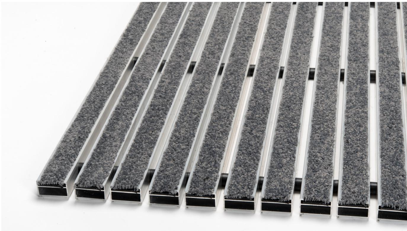
Le ROSCO VARIO PO – PGO – composé d'un profil porteur en aluminium (PO) ou en aluminium laqué (PGO), dans les couleurs noir ou gris, avec une surface en fibres de polyamide. La face inférieure du profil en aluminium est pourvue entièrement de caoutchouc cellulaire destiné à éviter que le paillason claque au sol. Les profils en aluminium sont séparés par des rondelles en caoutchouc de 4 mm de largeur. Le tout est maintenu par un câble d'acier inoxydable de 2 mm de diamètre.
